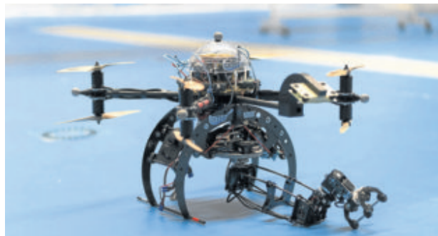
Dron provisto de brazos robóticos desarrollado por FADA-CATEC. / El Correo
