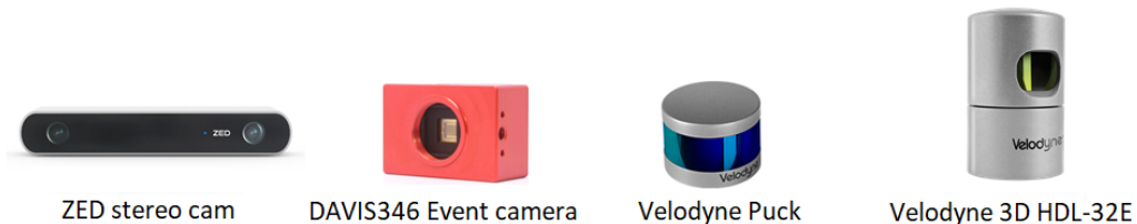
Figura 6. Ejemplos de sensores avanzados disponibles en los laboratorios de GRVC
