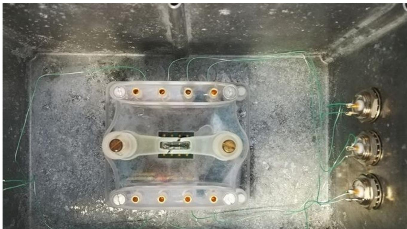
Montaje del chip de silicio empleado dentro de la caja que será introducida en el incubador.
